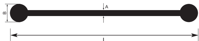
GIUNTO INTERNO DI RIPRESA GETTI PVC ALTA RESISTENZA PVC INTERNAL HIGH RESISTANT TAKE UP JOINT
