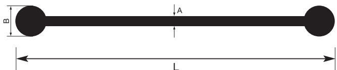
JOINT D'ARRÊT DE COULAGE INTERNE PVC HAUTE RÉSIDENCE JUNTA INTERNA DE FUNDICIÓN DE PVC ALTA RESISTENCIA
