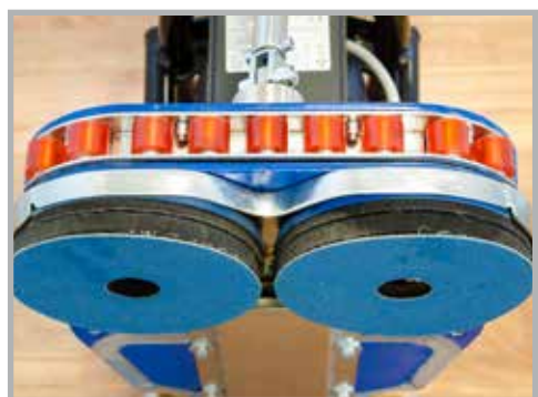
Nuovi rulli guida anti-traccia.
