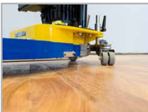
Ruote gemellari e pivottanti 360°.
