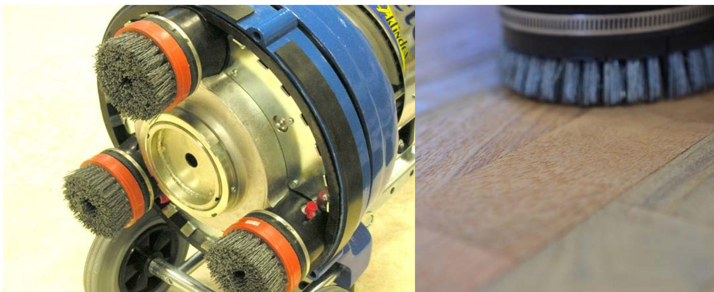
TIMBA è ideale anche per la spazzolatura e l'anticatura dei pavimenti in legno, senza la necessità di seguire la vena del legno, permettendone così l'applicazione anche su pavimenti a mosaico.
